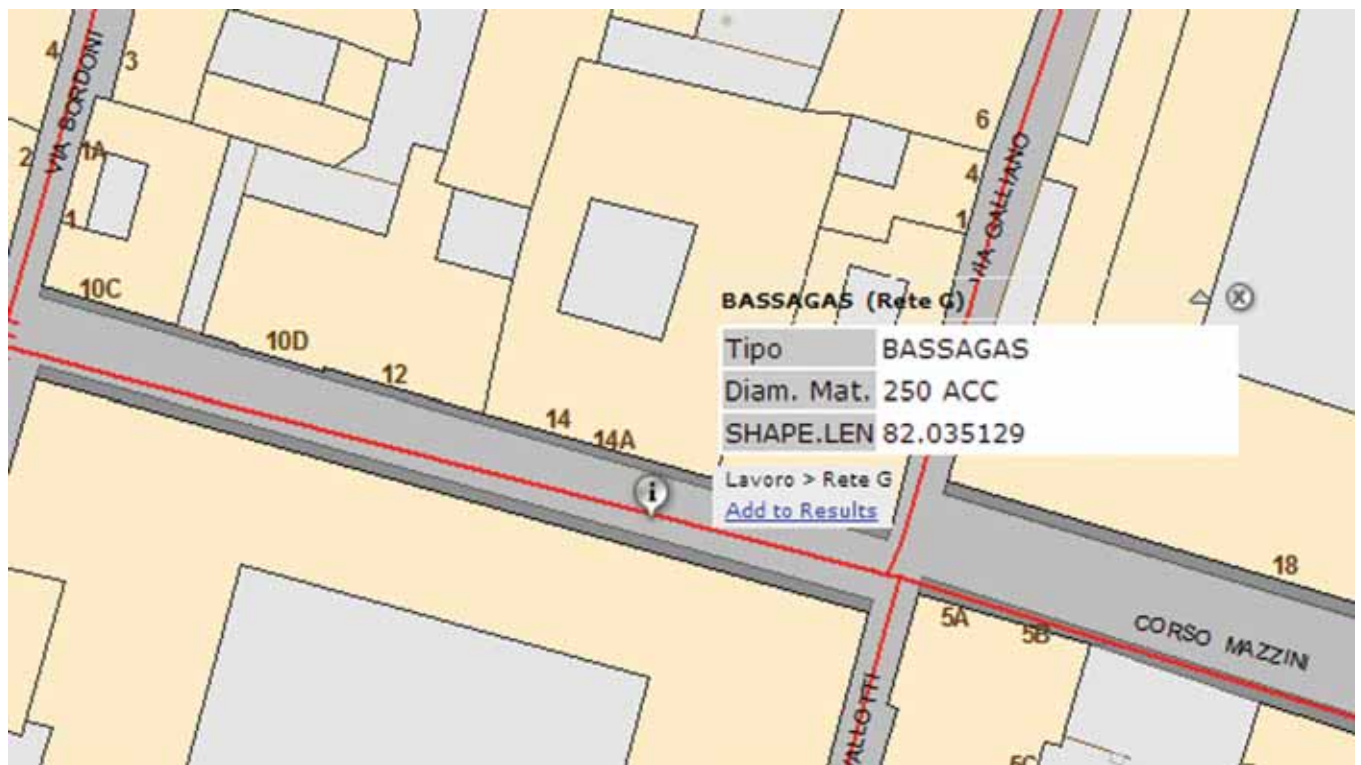
Fig. 9: esempio d'interrogazione relativa ad un elemento appartenente alla rete gas; in particolare, l'arco in esame è costituito da una tubazione in acciaio di diametro 250 mm.
