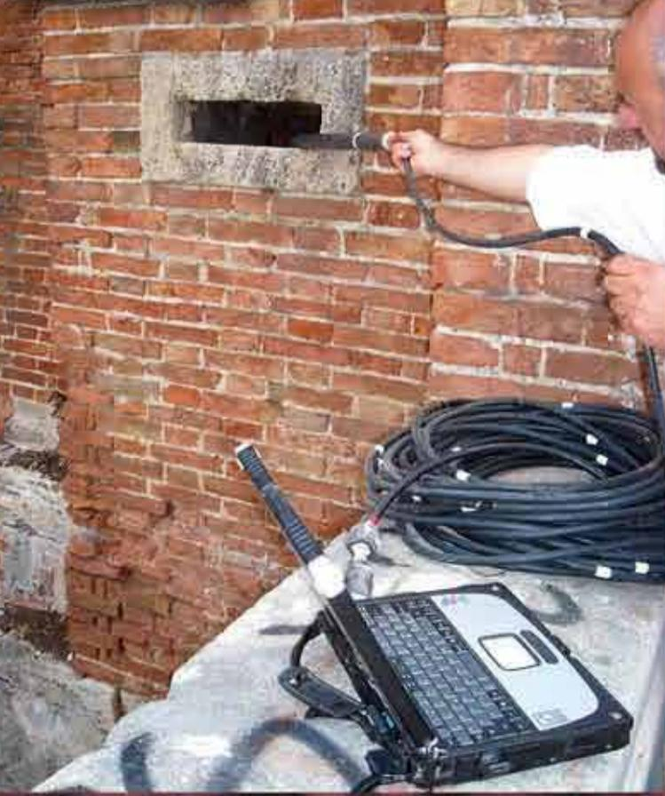
L'impiego del Georadar permette di individuare e localizzare, generalmente entro i primi 3 mt. di profondità, tutti i sottoservizi in genere quali fognature, strutture metalliche, tubazioni generiche (PVC, metallo, cemento, etc.), reperti archeologici, cavità, armature di pavimentazioni in cemento armato, fratture in manufatti, scavi recenti, riporti di materiale, ecc.
